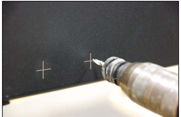
Abb.: beim Bohren eine Tiefenbegrenzung verwenden
