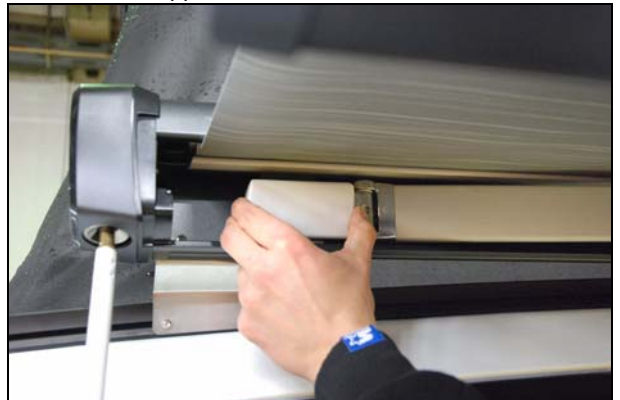
Abb.: das Ende eines Gelenkarmes vor einem Bohrloch
